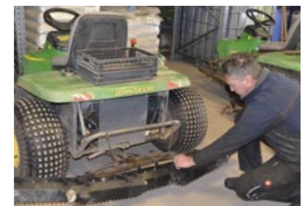
Die Rechen aller Bunkermaschinen wurden generalüberholt. Neue Zinken, alle beweglichen Teile sind neu gelagert und final wird von TP der Rechen justiert.
