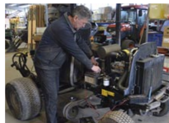
Thomas Papadopolous führt im Rahmen der Winterwartung eine Erhaltungsladung an der Batterie eines Fairwaymähers durch.
