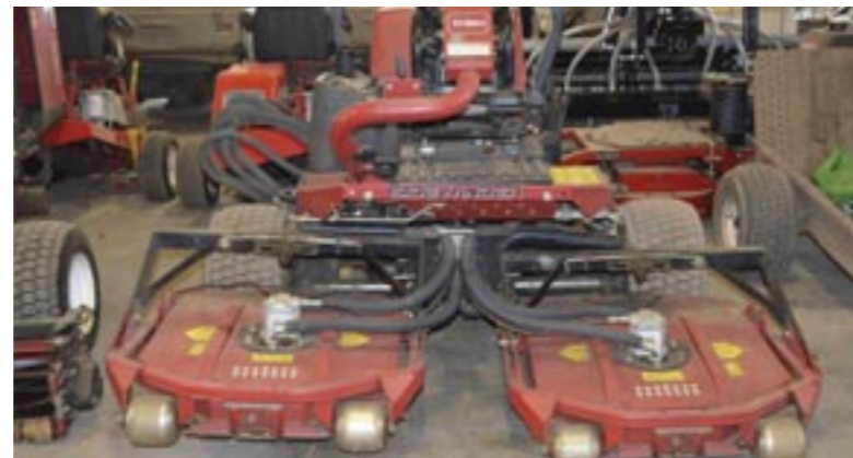
Der Sidewinder mit Sichelmähddeck wird im Bereich des Semi-Roughs eingesetzt, um die Blütenriebe der Gräser zu schneiden. Spindelmäher können die Blütenstände nicht schneiden, da sie keine Saugwirkung beim Schneiden erzeugen.
