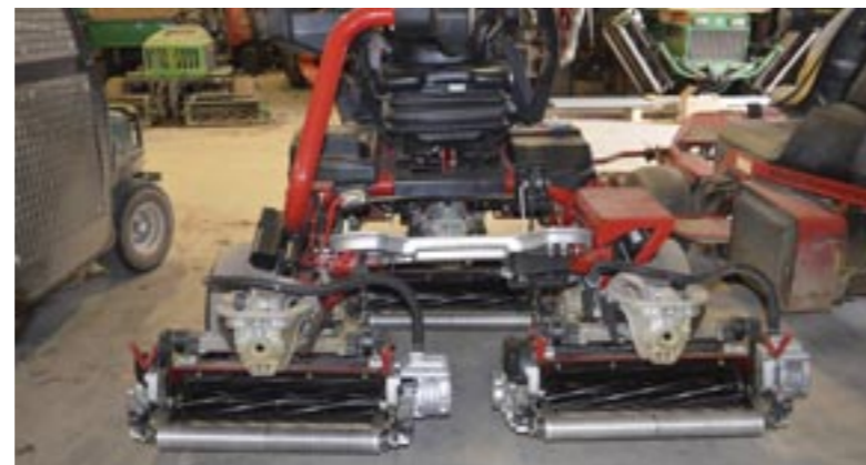
Der Toro Greensmaster 3360, ist unser neuer Greensmäher von 2022. Die spezielle Halterung der Schneideeinheiten sowie die getrennten Frontrollen machen den Triplexmäher vergleichbar mit einem Handmäher. Zusätzlich werden die Einheiten und der Fahrtrieb elektrisch bedient. Der Motor dient lediglich zur Stromerzeugung. Öl-Leckagen auf dem Grün gehören somit der Vergangenheit an.
