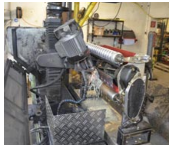
Spindelschleifmaschine von TP im Einsatz. Jedes Messer, sowie das Untermesser wird einzeln geschliffen.
