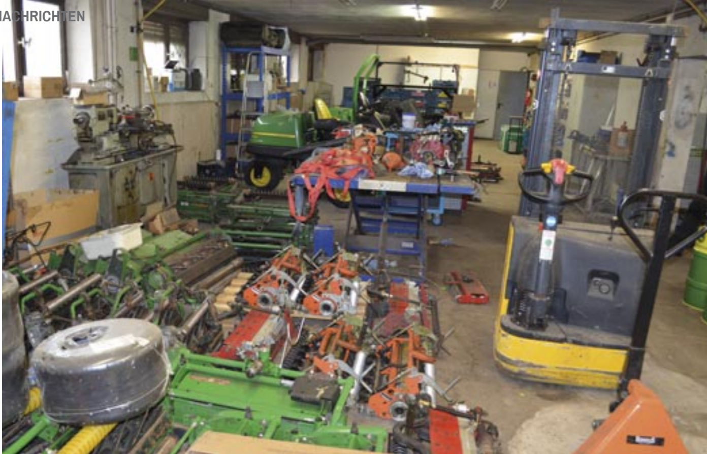
Abgebaute Spindeln verschiedenster Maschinen, die geschliffen, neue Untermesser bekommen und neu gelagert werden.
