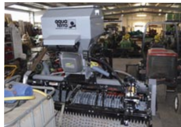
Der Aerevator UA-80 mit aufgesetztem Saatkasten dient der Nachsaat auf allen Flächen. Mit der Saateinheit lässt sich auch das kleine (0.5mm) Agrostis-Saatgut aufs Gramm genau (2gr./qm) ausbringen. Zusätzlich können die einzelnen Wellen getauscht und die Maschine kann zum Lockern der Spielbahnen verwendet werden.
