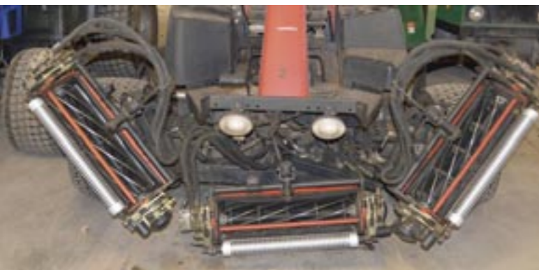
Einer von drei Fairwaymähern, mit annähernd 4000 Betriebsstunden (400.000 km) und 9 Jahren, eine Maschine die zeitnah erneuert werden muss.
