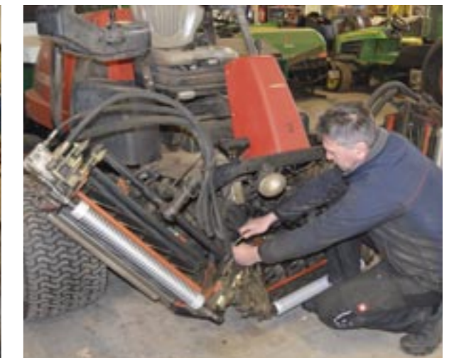
TP stellt vor jedem Einsatz die Schneideinheit nach, damit das Schnittbild optimal ist.
